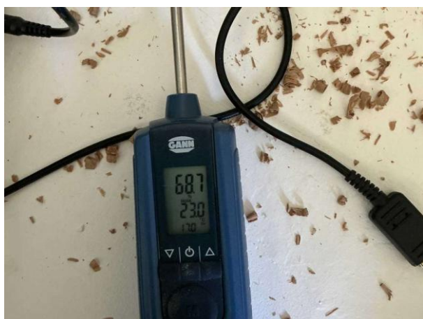
Bild 9: Invändigt, Entréplan, Fuktkontroll utförd under gränsvärde se bilaga 4
