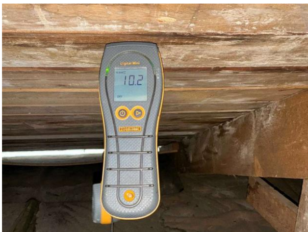
Bild 3: - Utvändigt, Vind, Fuktkontroll utförd under gränsvärde se bilaga 4
