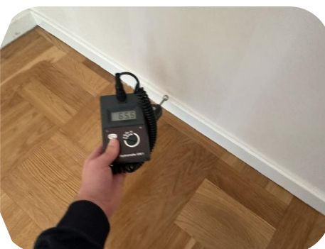
Normala fuktindikationer noterades på väggar mot badrummet från kökets sida samt från vardagsrummets sida.
