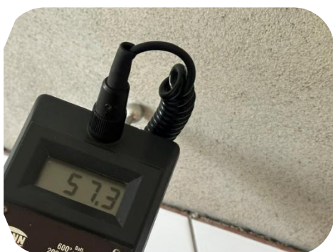
Normala fuktindikationer noterades bakom kakelplattor som släppt från väggen.
