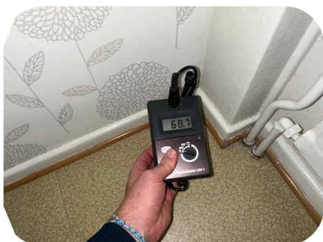
Normala fuktindikationer noterades på väggar mot badrummet från kökets sida samt från vardagsrummets sida.
